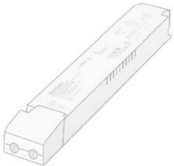
51515 200W / 24V DC Mått: L=369 mm, B=48 mm, H=30 mm C10A = 3 st, C16A = 5 st
