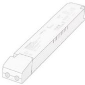
51515 200W / 24V DC Mått: L=369 mm, B=48 mm, H=30 mm C10A = 3 st, C16A = 5 st
